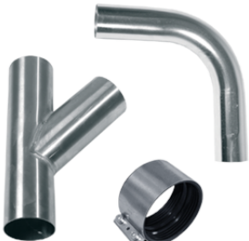
Rørsystem i sendzimir forsinket / elforsinket / galvanisert utførelse. Brukes til høyvakuum systemer og annen materialtransport av tungt/abrasivt støv og partikler. Skjøtes med rørklemmer. Materialtykkelse = 1,25–2,0 mm.
