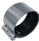
PICO Rørkobling Galvanisert og med ledende gummi. Lengde 65 mm. 2 stk bolter M8 x 40 mm. ø50–203 mm.
